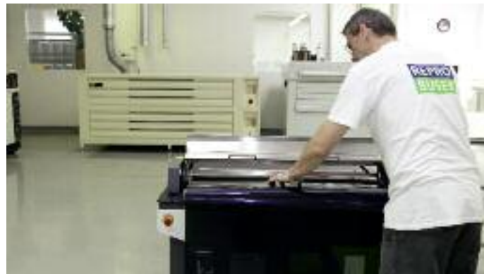
Der Thermal-Imaging-Träger wird im Laminator in einem rein mechanischen Vorgang ohne Temperatureinwirkung auf die NX Flexoplatte laminiert.
