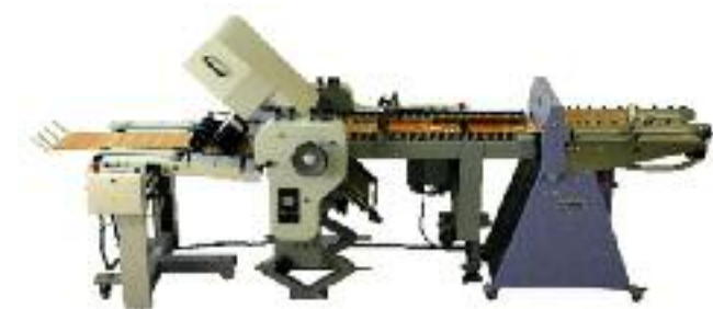
Kartonfalzwerk mit langer Bandauslage.
