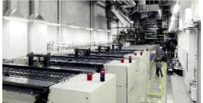
der umstellbare Überbau und Falzapparat mit einem 3. Falz bis 65.000 Zylinderumdrehungen.
