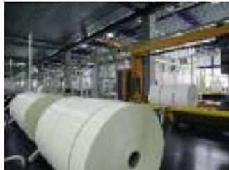
Frisch geschnittene Haftmaterialrollen warten auf den neuen Rollentischen auf den Transport ins computergesteuerte Sortierlager. Dort werden diejenigen Rollen unterschiedlicher Materialien und Längen automatisch zusammengefasst, die zu einem Kundenauftrag gehören.
