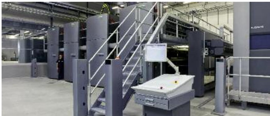
Makulatur im Druck signifikant senken, eine größere Produktvielfalt herstellen, kleinere Auflagen bewältigen und Auftragsvolumina von anderen Druckverfahren wie etwa dem Tiefdruck abziehen können. Dies lässt sich mit dem 96-Seiten-Druckmaschinenformat realisieren.
