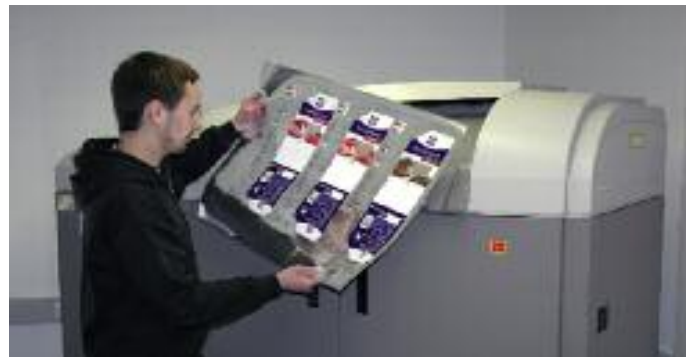
Mit einem Kodak Approval NX Digitalfarbproofsystem werden bei Nägele farbverbindliche, gerasterte Proofs auf Original-Bedruckstoffen ausgegeben.
