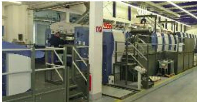
Mit knapp 35 m Länge und umfangreicher Ausstattung für den Kartonagen- und Bogenoffset-Druck ist die Rapida 162a bei SCA Packaging in Hanau eine der modernsten Anlagen für die Verpackungs- und Displayproduktion.
