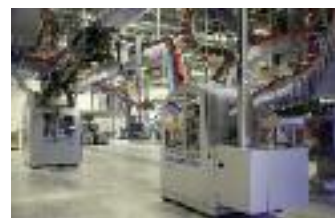
Auf der Ferag-Anlage produziert MittMedia Print AB in Sundsvall gehaftete und geschnittene Magazine mit bis zu 96 Seiten Umfang und mit einer maximalen Geschwindigkeiten von bis zu 45.000 Exemplaren pro Stunde.
