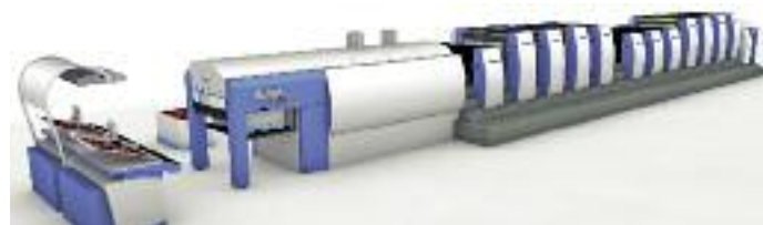
Die Rapida 106-Achtfarben in der Konfiguration 4 Farben + Lack + Trocknung + Trocknung + Wendung + 4 Farben + Lack + Trocknung/Auslageverlängerung wird im Sommer 2012 bei Saint-Paul AG in Freiburg installiert.
