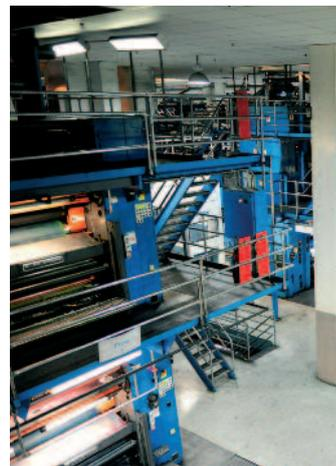
Drucktürme an zehn Druckstraßen mit QuadTechs Farbregelungs- und Bahneninspektionssystem mit Accu-Cam und dem Registerregelsystem mit MultiCam aus.
