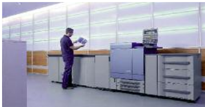
Der bizhub Press C8000 verarbeitet Medien bis zu 350 g/m 2 bei einer Geschwindigkeit von bis zu 80 A4-Bogen pro Minute.
