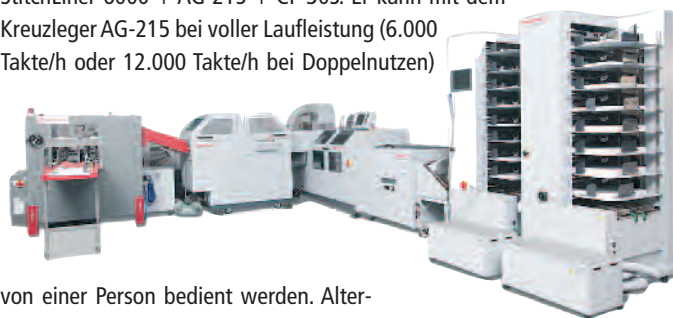
Die Digital Book Solution produziert Buchblocks mit 4-, 6- oder 8-seitigen Signaturen im Nonstop-Betrieb, bei Leistungen von 200 m/Min.
