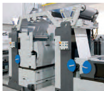
Ausschnitt aus einer Gallus ICS 670-Produktionslinie: links ein Kaltfolienmodul, rechts ein HiDef Flexodruck-Modul, jeweils auf einer Easy Value Add-Plattform positioniert.
