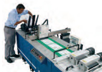
Der K600i ist für Druckbreiten von 108 mm bis 557 mm konfigurierbar.
