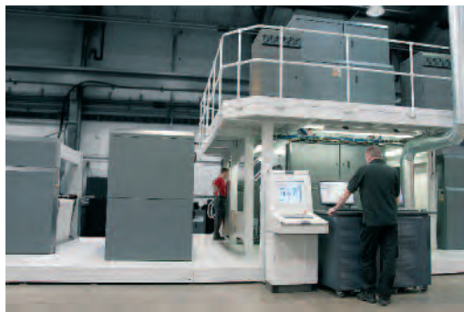
Hier hat der Digitaldruck längst industrielle Dimensionen angenommen: Inkjet-Druckköpfe von Kodak kommen bei der T-Press von Timsons zum Einsatz.
