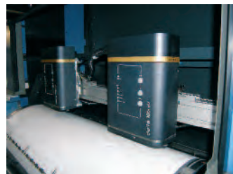
Digitale High-Speed Bogencodierung mit dem integrierten Delta 105i Drucker von Atlantic Zeiser.
