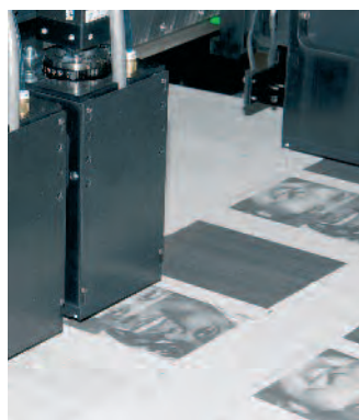
Inkjet-Druckköpfe von Kodak kommen auch bei der T-Press von Timsons zum Einsatz.
