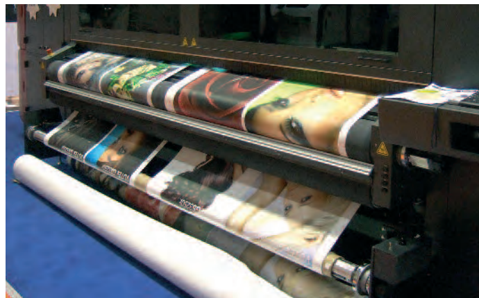
Der GS3250r ist die etwa drei Meter breite EFI-Lösung für das Wide Format.
