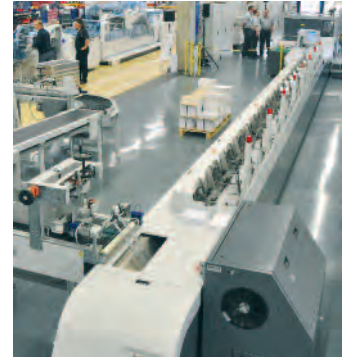
Der Klebinder Eurobind Pro kann mit einer Buchproduktionslinie von Hunkeler kombiniert werden.
