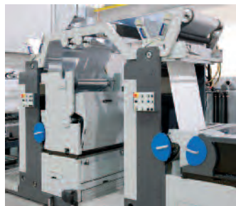
Ausschnitt aus einer Gallus ICS 670-Produktionslinie: links ein Kaltfolienmodul, rechts ein HiDef Flexodruck-Modul.
