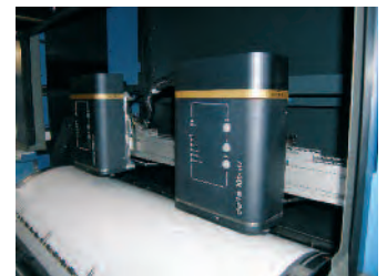
Digitale High-Speed Bogencodierung mit dem integrierten Delta 105i Drucker von Atlantic Zeiser.
