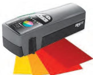
das Verstehen von CIE L\*a\*b\* Farbwerten einfacher als je zuvor. Ausgestattet mit LED-Technologie liefert das Gerät auch eine D50-Beleuchtung und erfüllt damit die Anforderungen der Messbedingung M1 gemäß ISO 13655. Die neue Konstruktion des Messkopfes ermöglicht außerdem zuverlässige Messungen
