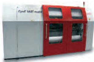
Die durchgehenden Flexo-Sleeves des DuPont Cyrel Fast Round 1450 FR ermöglichen einen schnellen Wechsel zur Druckpresse, hohe Druckpressengeschwindigkeiten und die Möglichkeit, qualitativ hochwertige Designs nachhaltiger zu drucken. Foto: DuPont.
