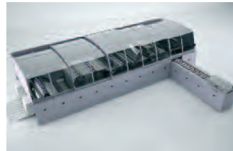
DCbook von E.C.H. Will: Geschwindigkeiten bis zu 300 m/Min. und eine Leistung von bis zu 12.600 Büchern pro Stunde bedeuten Produktivität auf Augenhöhe mit konventionellem Offsetdruck.
