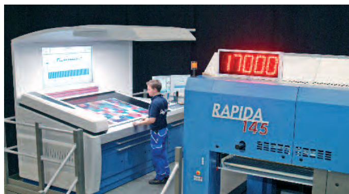
Mit der Rapida 145 stellt KBA auf der drupa seine neue Großformatgeneration vor, die mit 17.000 Bg/h. produziert, und bei der viele technischen Merkmale von der Rapida 106 übernommen wurden.
