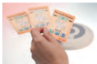
PolyLogo-RAD funktaktivierbare Displays ermöglichen eine interaktive Verbindung mit dem Nutzer durch die Integration einer elektronischen Anzeige zum Beispiel in Karten oder Verpackungen.
