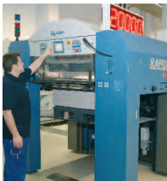
KBA lässt seine Rapida 106 mit 20.000 Bg/h laufen. Auch die Rapida 145 kommt auf 17.000 Bg/h.
