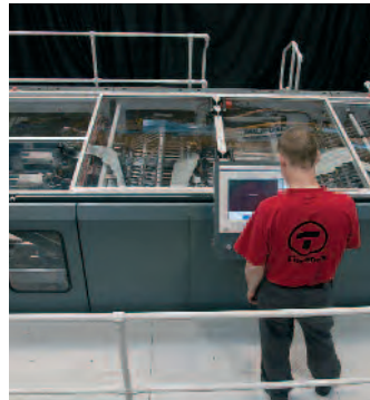
Hier hat der Digitaldruck industrielle Dimensionen angenommen: in der Inkjet-T-Press von Timsons.
