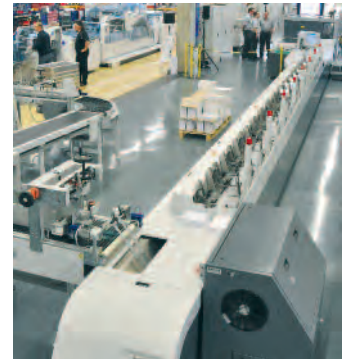
Der Klebebinder Eurobind Pro kann mit einer Buchproduktionslinie von Hunkeler kombiniert werden.
