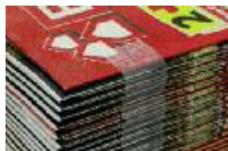
TapeFix: ein neuartiger Weg zur Fixierung von Beilagenkollektionen. Statt eines Umschlags sichert das selbsthaftende TapeFix den Zusammenhalt der Kollektionen.
