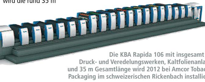
Die KBA Rapida 106 mit insgesamt 19 Druck- und Veredelungswerken, Kaltfolienanlage und 35 m Gesamtlänge wird 2012 bei Amcor Tobacco Packaging im schweizerischen Rickenbach installiert.
