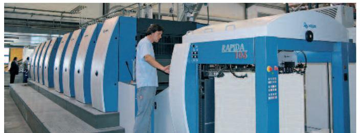
Seit 2009 produziert bei der Imprimerie Rochelaise eine Achtfarben-Rapida 106 für die 4 über 4-Produktion. Auch sie wurde über KBA LogoTronic in den CIP4-Workflow integriert.
