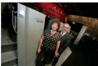
Maggie und Jeff Williams von dem britischen Werbepublisher Alpha Colour vor der auf der drupa gekauften klimaneutralen Speedmaster XL 75 Vierfarben mit Lackwerk von Heidelberg. Die Maschine visualisiert mittels eines Messgeräts die Energieeffizienz der Maschine je 1.000 Bogen während der Produktion.
