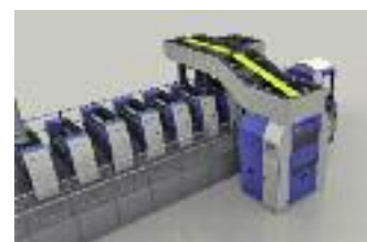
Das seitlich angeordnete Vinfoil-Kaltfolienmodul an der KBA Rapida 106 für Amcor Tobacco Packaging.
