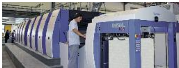
Seit 2009 produziert bei der Imprimerie Rochelaise eine Achtfarben-Rapida 106 für die 4 über 4-Produktion. Auch sie wurde über KBA LogoTronic in den CIP4-Workflow integriert.
