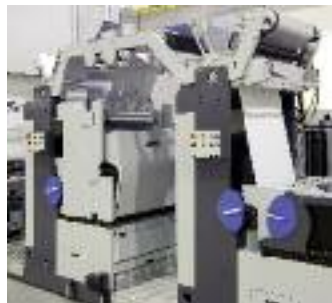
Das Kaltfolienmodul sorgt für vielseitige Gestaltungs- und Überdruckmöglichkeiten.
