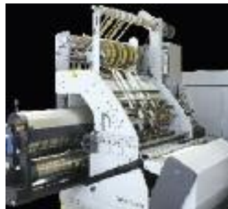
Das rotative Reliefschnittgravur-Modul vereint Heißfolien- und Reliefprägung in einem Arbeitsgang.
