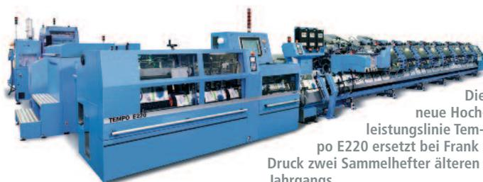
Die neue Hochleistungslinie Tempo E220 ersetzt bei Frank Druck zwei Sammelhefter älteren Jahrgangs.
