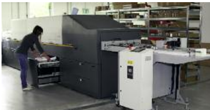
Die Kodak NexPress SX3300 Digitaldruckmaschine ergänzt bei der Häuser KG den Offsetdruck-Maschinenpark. Sie wird für die Kleinauflagenproduktion und spezielle Druckeffekte eingesetzt.
