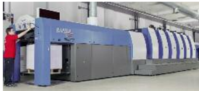
Noch vor der neuen Akzidenzrotation KBA C16 wird im Werk Gersthofen von ADV Schoder Anfang August eine Mittelformatmaschine KBA Rapida 106 mit fünf Druckwerken und Dispersionslackwerk anlaufen.
