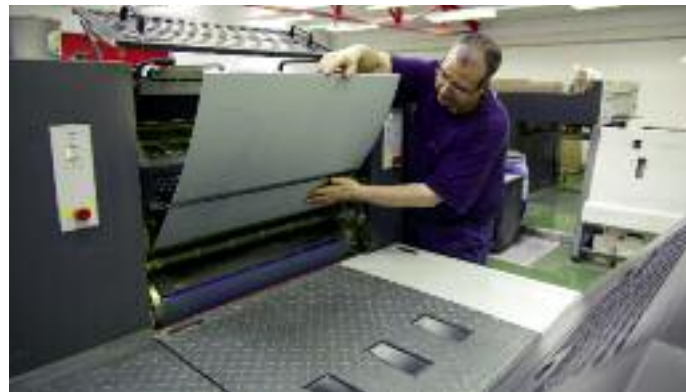
Offsetdrucker Ennio Dell'Anna spannt eine bebilderte Sonora XP Platte in der Sechsfarben-Bogenoffsetmaschine ein.
