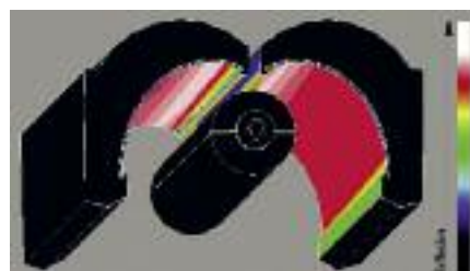
Eine optimierte Reflektorgeometrie und ein verbessertes Wärmemanagement der Strahler verbessern die Energieeffizienz beim Trocknen.
