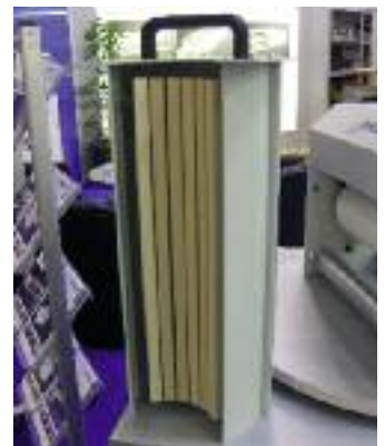
Das ›Easy-Change-Schnellwechselsystem‹, eine inklusive Ansaugrohr und Staubfänger entnehmbare Elektrodenkassette, ermöglicht eine schnelle Wartung und Reinigung der kompletten Anlage.
