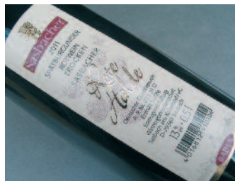
Bei Vollherbst werden vorgestanzte Etiketten im Offsetdruck mit Markenname und Bild in hoher Auflage vorgedruckt. Der Inkjet-Eindruck erfolgt für Informationen wie Lage, Rebsorte und Jahrgang.
