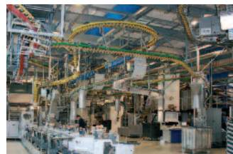
Das Vorsammelsystem RollStream ist mit sechs Anlegern ausgestattet.
