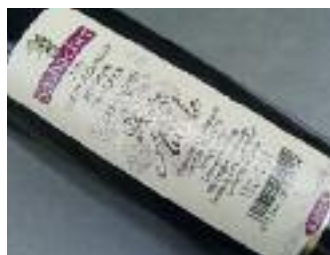
Bei Vollherbst werden vorgestanzte Etiketten im Offsetdruck mit Markenname und Bild in hoher Auflage vorgeduckt. Der Inkjet-Eindruck erfolgt für Informationen wie Lage, Rebsorte und Jahrgang.
