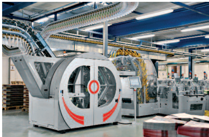
Mundschenk hat EasySert mit sechs JetFeeder-Anlegern für die 6-in-1-Produktion ausgestattet.
