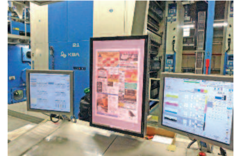
Einer der drei ErgoTronic-Leitstände: Links der Monitor für die Registersteuerung, in der Mitte der Softproof-Monitor, rechts der Touchscreen für die Maschinensteuerung.
