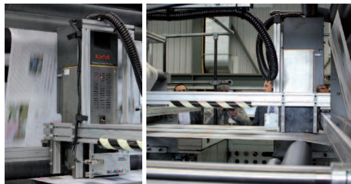
Die Rotation produziert mit Bahngeschwindigkeiten bis 13,2 m/s, womit die Kapazität des Prosper S30 Systems (max. 15 m/s) noch nicht ganz ausgereizt wird. Der Druckkopf wird über eine Traverse in Position gefahren.
