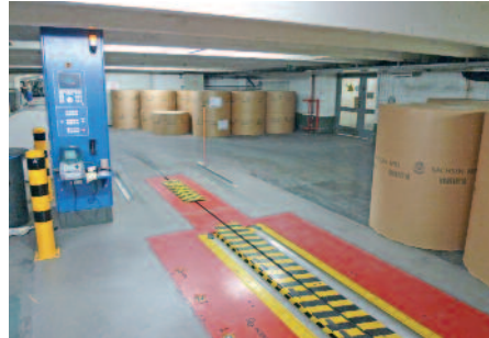
Niedriger Rollenkeller: Im Vordergrund die Wiegestation der KBA-Logistiklösung Patras A.
