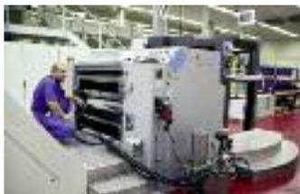
Am Schweizer Standort Rickenbach hat Amcor in eine neue Bogentiefdruckmaschine 1-TBR Compact von Moog investiert.
