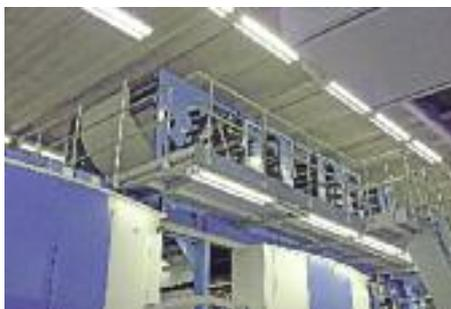
Passt genau: Gerade einmal 40 Zentimeter Platz sind noch zwischen dem Überbau der Commander CT und der Hallendecke.
