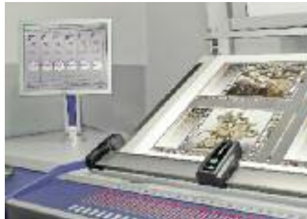
KBA QualiTronic Instrument Flight: Inline-Farbregelung an Bogenmaschinen mit externem Scan-Spektralgerät zur Kalibration.
