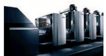
Mit dem Lackwerk der Speedmaster CX 102 können sowohl UV-Lack als auch wasserbasierte, Glanz-, Matt- und Effektlacke aufgetragen werden.
