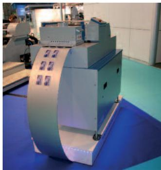
Mit der OC 200 können Karten bis zu 1,2 mm Stärke bedruckt werden. Auch Karten mit Chipvertiefungen, Mini SIM oder Magnetstreifen können verarbeitet werden.
