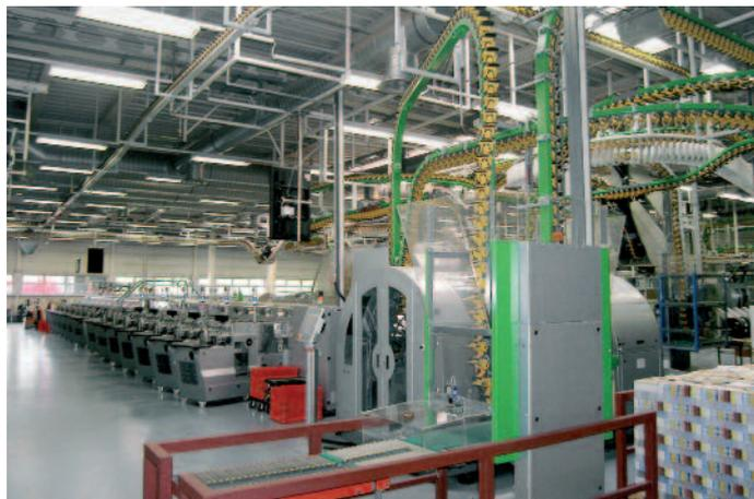
Das FlyStream-Vorsammelsystem ist für die 20-in-1-Produktion ausgelegt und bewältigt das gestiegene Beilagenvolumen.
