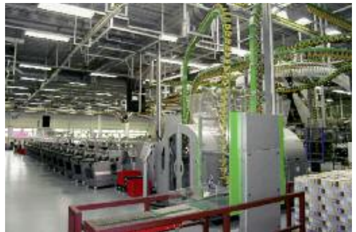
Das FlyStream-Vorsammelsystem ist für die 20-in-1-Produktion ausgelegt und bewältigt das gestiegene Beilagenvolumen.
