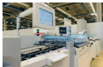
Der Stahlfolder TH 56 von Heidelberg arbeitet als Inlinefolder nahtlos mit den Modulen von Hunkeler zusammen und falzt Bogen, die von einer digital bedruckten Rolle in einem Arbeitsgang abgewickelt und quer geschnitten werden.
