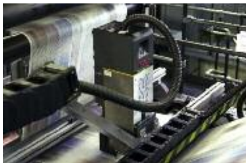
Erhebliche Fortschritte erzielte Kodak bei seinen Eindruckköpfen. Mit dem Prosper-S30-Kopf werden bei Axel Springer in Ahrensburg in einer Rotation Geschwindigkeiten von 13,2 m/Sek. erreicht.
