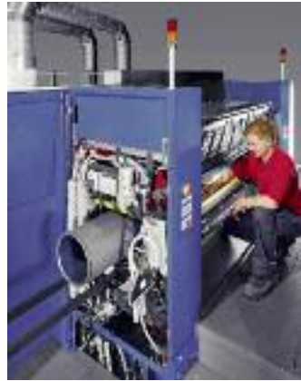
Wechsel der Rasterwalzen-Sleeves bei laufender Produktion am Lackturm.
