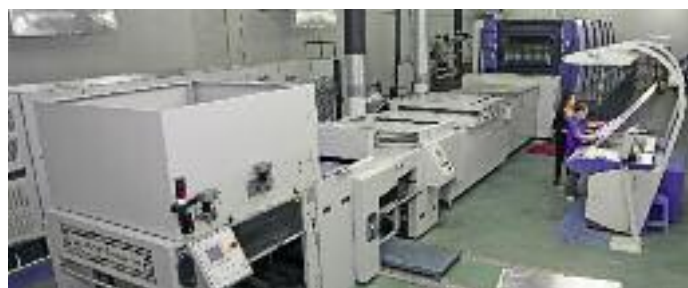
30% ihres Umsatzes erzielt die KBA-Gruppe heute schon in Drucksegmenten außerhalb der klassischen Märkte für Bogen- und Rollenoffsetmaschinen. Hier eine Blechdruck- und Lackierlinie der Stuttgarter Tochtergesellschaft KBA-MetalPrint GmbH für China Food Packaging.
