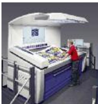
Der neue KBA ErgoTronic-Leitstand hat einen großen Wallscreen und kann mit verschiedenen integrierten Messsystemen zur Qualitätsregulierung ausgestattet werden.
