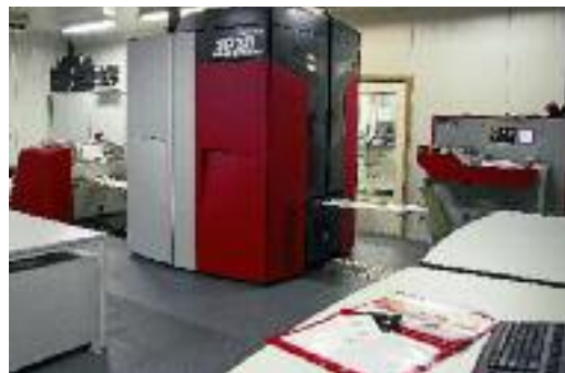
Kein Spiegelbild, sondern die beiden neuen Modelle Xeikon 3030Plus und 3300 beim belgischen Etikettendrucker Femalabel. Damit erhöhte das Unternehmen seine Kapazität um 300%. Die Xeikon 3030Plus ist ein Drucksystem mit 330 mm Rollenbreite und einer Geschwindigkeit von bis zu 15 m/Min.
