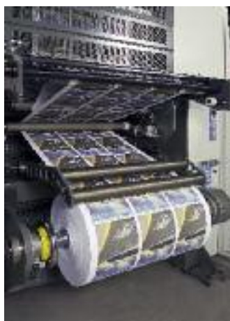
In Luzern produzierte die RotaJET 76 mit dem neu entwickelten KBA Rewinder.
