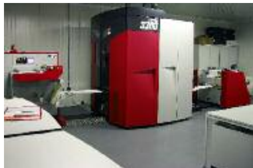
Kein Spiegelbild, sondern die beiden neuen Modelle Xeikon 3030Plus und 3300 beim belgischen Etikettendrucker Femalabel. Damit erhöhte das Unternehmen seine Kapazität um 300%. Die Xeikon 3030Plus ist ein Drucksystem mit 330 mm Rollenbreite und einer Geschwindigkeit von bis zu 15 m/Min.
