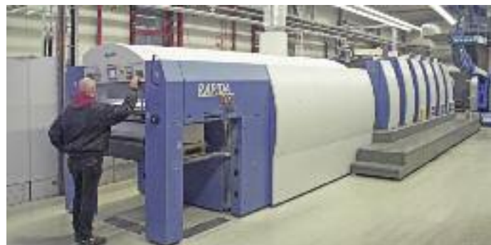
Die 2011 installierte KBA Rapida 106 verfügt über das Farbmess- und -regelsystem KBA QualiTronic Color Control plus System Brunner Instrument Flight.
