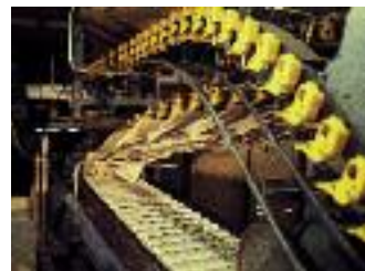
Mit der Transporteurtechnik von Ferag will Times Union die Spitzen von 80.000 Ex/h stabil in die Weiterverarbeitung übertragen.
