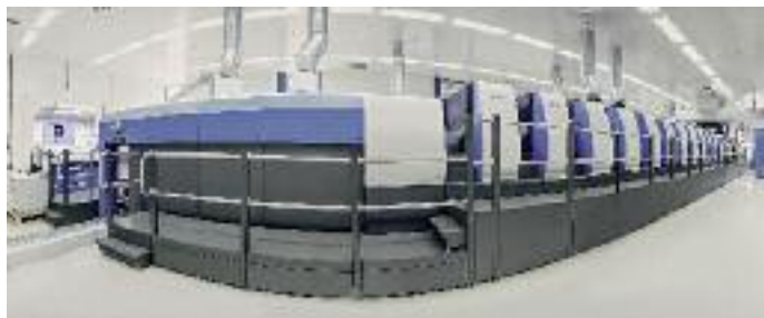
Die bei Amcor Tobacco Packaging in Rickenbach/Schweiz produziert eine KBA Rapida 106 mit 19 Druck- und Veredelungswerken und setzt im Bogenoffset-Verpackungsdruck weltweit neue Maßstäbe.
