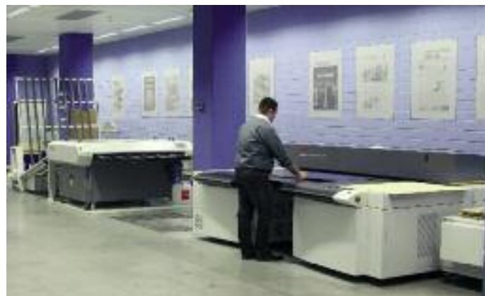
Ein Kodak Magnus VLF 5570 Quantum Plattenbelichter als Halbautomat vervollständigt die CtP-Kapazität und dient als Backup.
