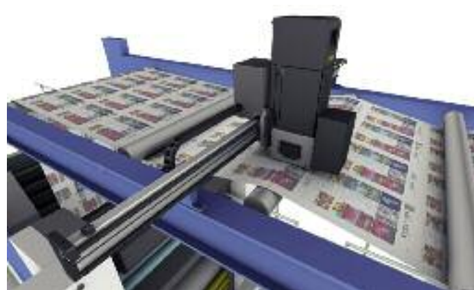
Offsetrotation (hier die Standardvariante mit einem Druckkopf). Auch zwei oder mehrere Druckköpfe für eine größere Eindruckfläche sind möglich.
