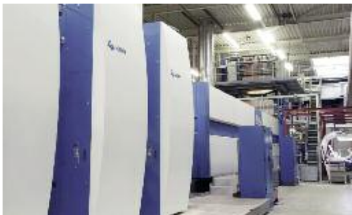
Die KBA C56 SG mit einer maximalen Papierbahnbreite von 2.280 mm ist bisher die einzige Rotation für 56 liegende Seiten am Markt.
