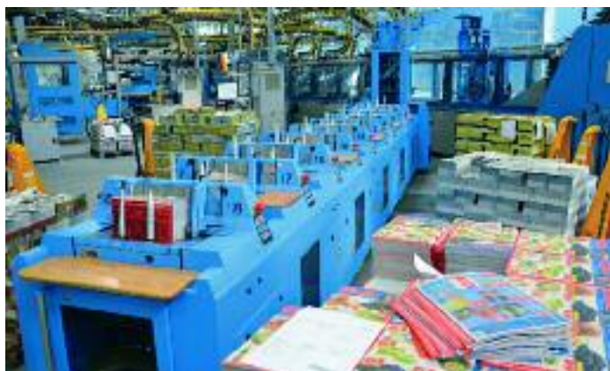
Die Kombi-Lösung NewsLiner/CoLiner in Kiel ist die weltweit erste dieser Art. Stefan Will (rechts), Leiter Prozessorganisation Weiterverarbeitung bei der Kieler Zeitung GmbH & Co. Offsetdruck KG: »Weil der CoLiner keine Ketten mehr hat, brauchen wir weniger Verschleißteile und haben geringere Instandhaltungs- und Lebenszykluskosten.« Links Roland Prieske, Niederlassungsleiter Müller Martini Deutschland.
