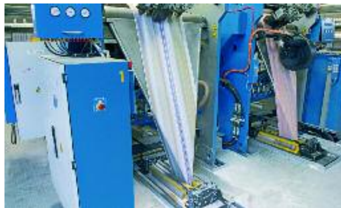
Überbau mit Skip Slitter auf dem 2. Trichter. Die damit verbundenen einzigartigen Produktionsmöglichkeiten entlasten die Weiterverarbeitung.
