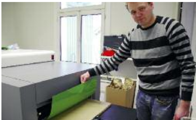
Seit der Umstellung auf den neuen Kodak-CtP-Belichter arbeitet Tobias Lutz mit der Toray LL7-Platte. Dieser Plattentyp erlaubt einen vollautomatischen Verarbeitungsprozess.
