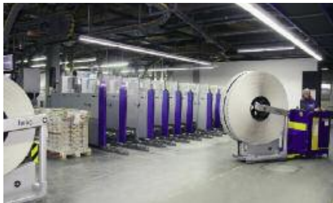
Mit einem Pufferlager DiscPool wurden beim Druckhaus Ulm-Oberschwaben Druck und Versandraum entkoppelt und können völlig losgelöst voneinander produzieren. Das Einstecken der Beilagen übernimmt eine MSD2-C-Einstecktrommel (rechts), die in Kombination mit dem Vorsammelsystem RollStream sechs Beilagen verarbeiten kann.
