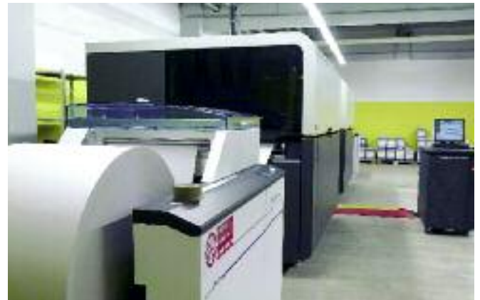
NP Newsprint Berlin druckt mit einer Kodak Versamark VL4200, das Finishing besorgen Maschinen von Hunkeler aus der POPP 6 Baureihe.
