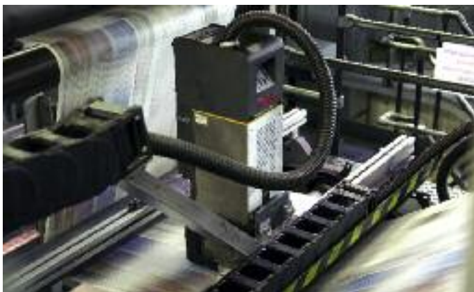
Der Kodak Prosper S30 Inkjet-Eindruckkopf in einer der Springer-Rotationen in Ahrensburg und ein Druckkopf mit Kamerasystem im Überbau einer KBA-
