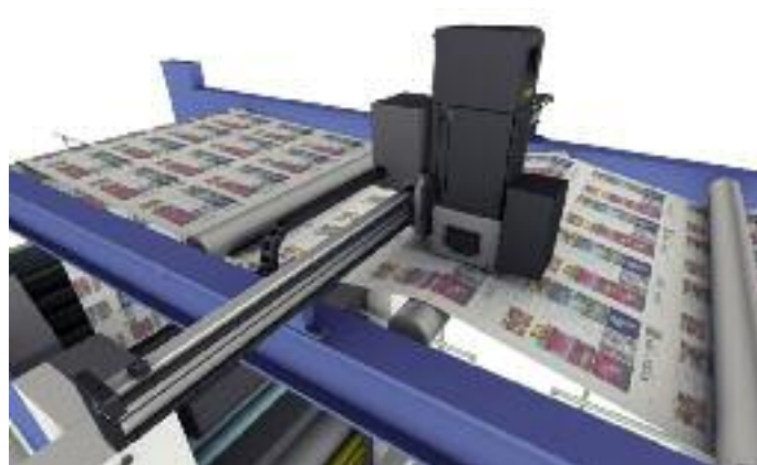
Offsetrotation (hier die Standardvariante mit einem Druckkopf). Auch zwei oder mehrere Druckköpfe für eine größere Eindrucksfläche sind möglich.
