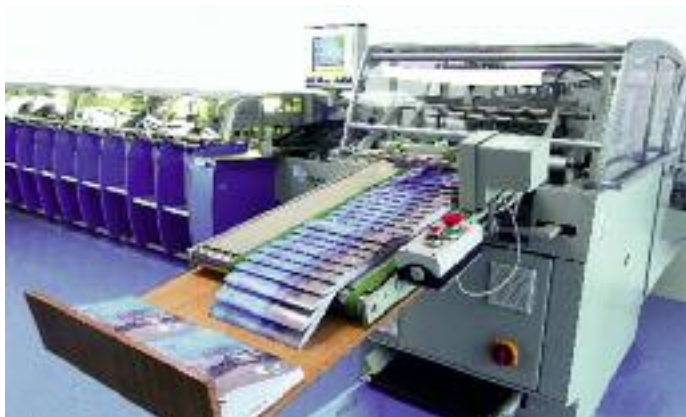
Fertig geheftete Broschüren verlassen eine MKW Rapid Trans UT mit angeschlossenem Zweifach-Trimmer Rapid T20.
