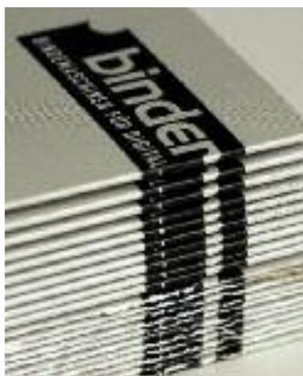
Vergleich von Drucken auf 250 g/m<sup>2</sup>-Material, die ungerillt beim Falzen aufplatzen, und Bögen, die nach dem Rillen beim Falzen nicht aufplatzen. Das Kartonfalzwerk (rechts) arbeitet mit 70 mm-Falzwalzen, um auch schwere gerillte Bogen beschädigungsfrei falzen zu können.
