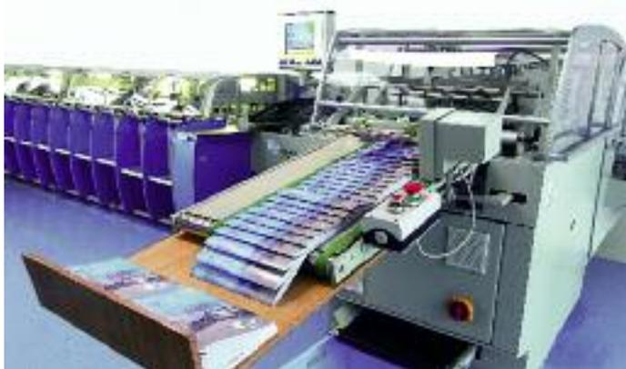
Fertig geheftete Broschüren verlassen eine MKW Rapid Trans UT mit angeschlossenem Zweifach-Trimmer Rapid T20.
