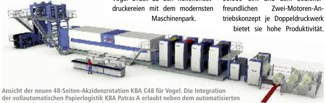
Ansicht der neuen 48-Seiten-Akzidenzrotation KBA C48 für Vogel. Die Integration der vollautomatischen Papierlogistik KBA Patras A erlaubt neben dem automatisierten Plattenwechsel auch den automatischen Papierwechsel in wenigen Minuten.
