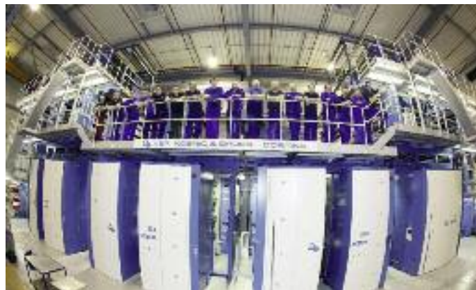
Die Profis der zum Südkurier Medienhaus gehörenden Druckerei Konstanz nutzen die verfahrenstechnischen Stärken ihrer ohne Feuchtwerke und Zonenschrauben arbeitenden Kompaktrotation KBA Cortina seit Jahren für kreative Werbeformen und nicht alltägliche Printprodukte.
