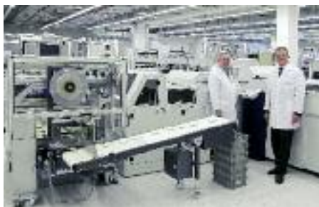
Drucken, Falzen, Stapeln, Banderolieren in einem Durchgang: Das Online-System sorgt für eine effiziente Produktion der Einbauanleitungen (im
