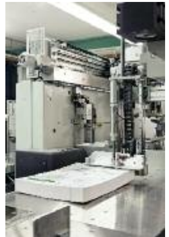
Automatische Beladung des Schnellschneiders über den Hintertisch.
