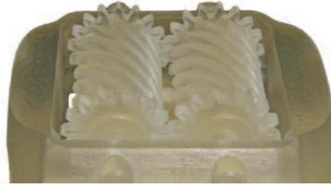
delling-Verfahren und bis zu mehreren hunderttausend Franken für einen Stereolithografie-Drucker. Die üblichen Schichtstärken, die von den Drucksystemen erzeugt werden, liegen je nach Auflösung zwischen 0,016 mm und 0,4 mm und die Dauer des Druckvorgangs kann je nach Verfahren, Größe und Komplexität des zu druckenden Objektes zwi-
