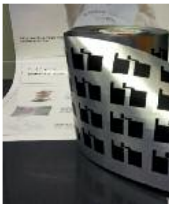
Flache Batterien (Ni-Metallhydrid) auf Folie von der Rolle gedruckt. Quelle: Varta.
