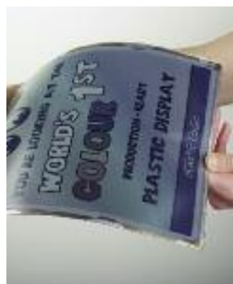
Flexibler elektrophoretischer Farbbildschirm für E-Reader oder Tablets mit Backplane aus organischen Transistoren (OTFT). Quelle: Plastic Logic.
