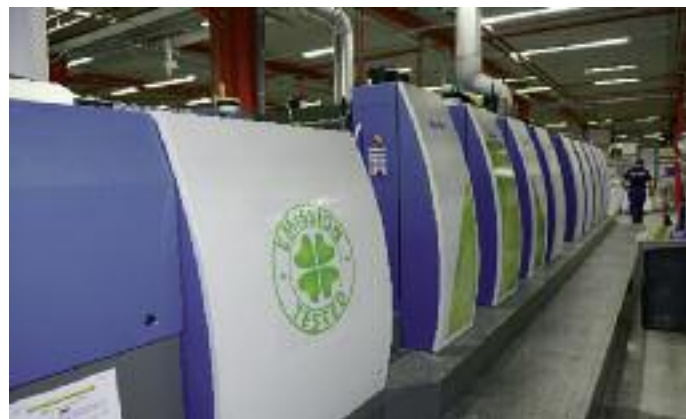
Bei Albe de Coker ging 2013 weltweit die erste Achtfarben-Rapida-106 mit HR-UV-Trocknern in Betrieb.
