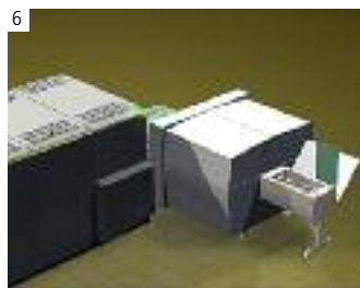
Die Grafiken veranschaulichen den einfachen Ablauf der Zeitungs-Druckformherstellung mit der prozessfreien Kodak Sonora News Platte in einem Generation News Plattenbelichter mit Registerstanz- und Abkanteinheit.
