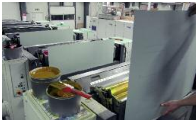
Sonora XP Platten werden an der Druckmaschine in die Schächte für den automatischen Einzug gestellt.
