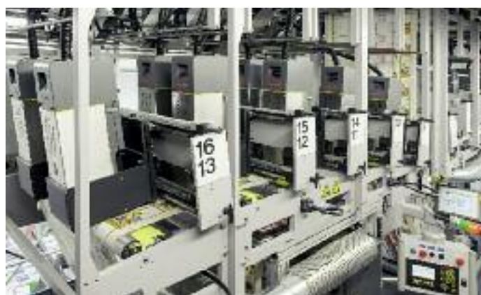
Kodak Prosper S10 Eindrucksysteme in den Inkjet-Towern einer Jet Web-Finishing-Linie.
