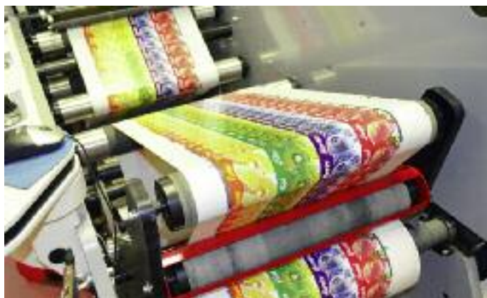
Das Siebenfarben-MP-System ermöglicht den Wechsel zwischen konventionellen und digitalen Druckverfahren ohne erkennbare Unterschiede in Sachen Qualität oder Farbton.
