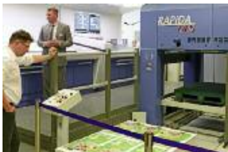
Chris Travis von KBA North America präsentierte die Nonstop-Stapellogistik an einer Rapida 145 bei voller Maschinenleistung.
