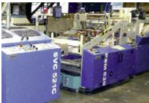
Ricoh Manager Finishing Asim Aydin (rechts) und MBO Projektleiter Steffen Merkle nehmen Einstellungen an der Mailing-Linie vor. Die neue MBO-Digitallinie, die im Ricoh Document Center in Brackenheim zur Mailingproduktion installiert wurde, besteht aus einem Abwickler, einem Split-und-Merge-Modul und einem Querschneider.
